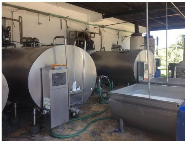
*Figura 20. Cubas de acero inoxidable con sistema de refrigeración*
